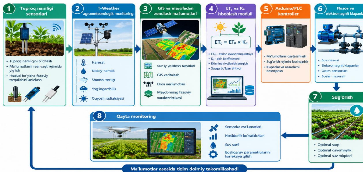
1-rasm. Intellektual sug'orish tizimining umumiy strukturaviy sxemasi
